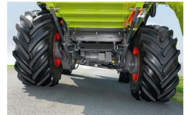
Eje delantero MONTANA con inclinación máxima
