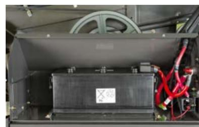
Una batería de 12 V abastece la electrónica de a bordo y la electrónica del motor. Colocada con un fácil acceso en la caja de la batería.
