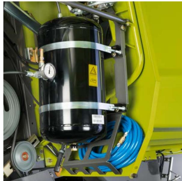
**NUEVO:** El paquete de confort para el mantenimiento.
