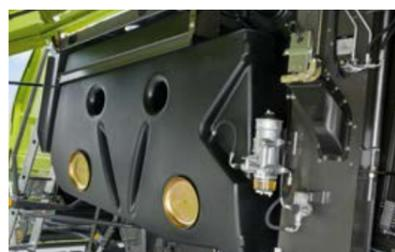
Depósito de combustible con hasta 750 l de capacidad
